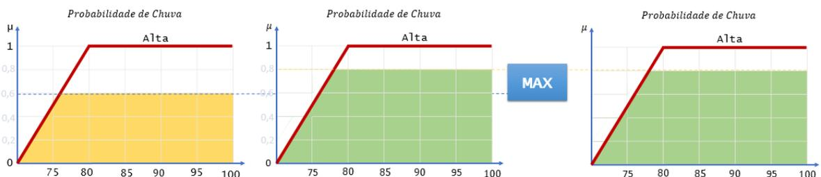
Figura 2.10 - Composição das regras 1 e 2 utilizando operador *max*.
