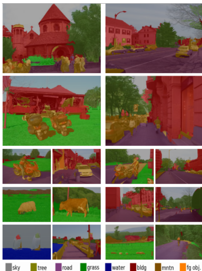
Figura 3.23: Resultados da segmentação e anotação do sistema de Socher et al. (2011). Cada pixel foi pintado com a cor correspondente à sua classe.
