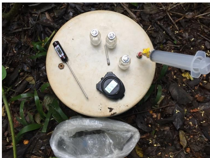
Figura 6. Câmara estática utilizada para coleta de gás. A imagem mostra uma câmara tampada, com seringa de coleta acoplada, frascos de amostragem, termômetro e cronômetro
