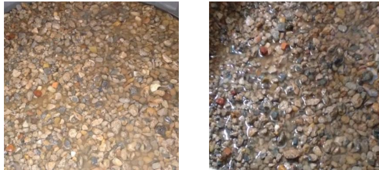
Figura 14 – Pré molhagem dos agregados reciclados
