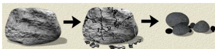
Figura 1 – Remoção da argamassa aderida ao agregado reciclado pelo processo de fricção (NAWA, 2010)
