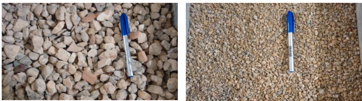
Figura 12 - Agregados graúdos reciclados a) D_{máx} igual a 25,0 mm, b) D_{máx} igual a 9,5 mm
