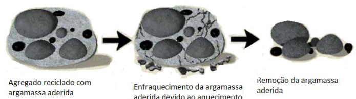
Figura 2 - Remoção da argamassa aderida ao agregado reciclado pelo processo de aquecimento (Adaptado de NAWA, 2010)
