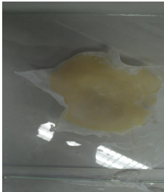
Figura 13 - Blenda PHB/Ecoflex® após total secagem e evaporação do solvente.
