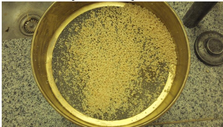
Figura 9 - PHB triturado sendo peneirado em peneira de Mesh 20.
