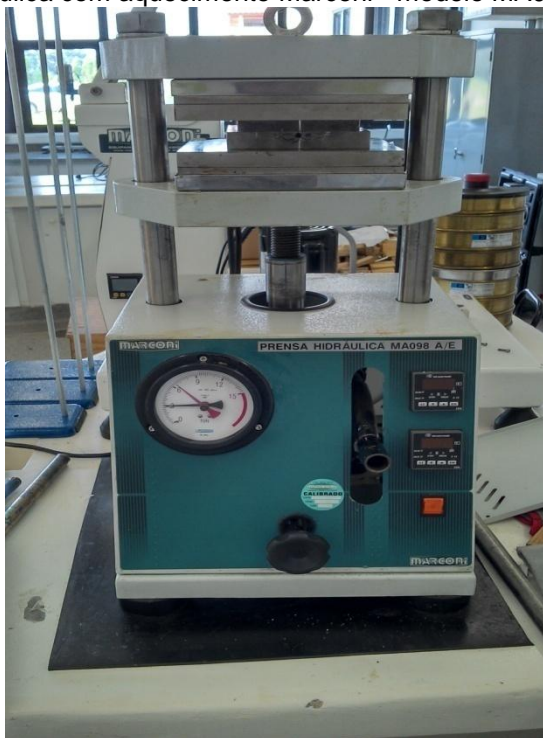
Figura 17 - Molde com a blenda de PHB/Ecoflex® em resfriamento
