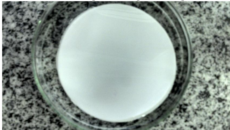
Figura 12 - Blenda PHB/Ecoflex® em placa de petri evaporando solvente
