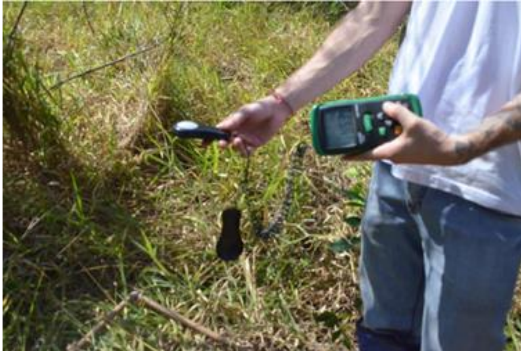
Figura 3: Avaliação da incidência de luz com o equipamento luxímetro a 1 metro do solo.
