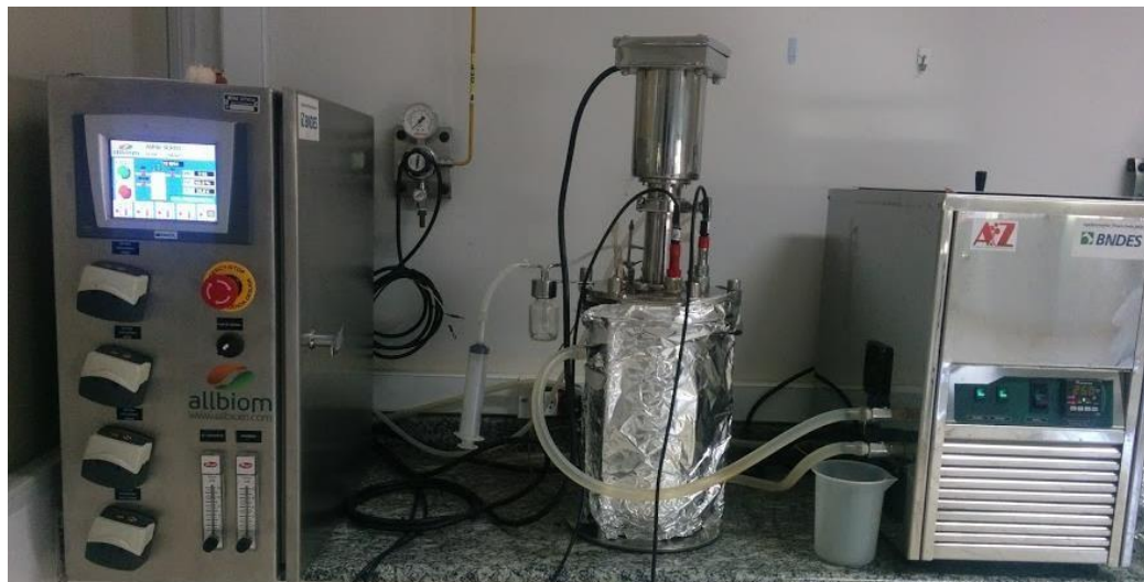
Figura 2 - Cultivo heterotrófico de A. microscopica em meio BG11 suplementado com vinhaça em biorreator Allbiom® AllMic SCR05
