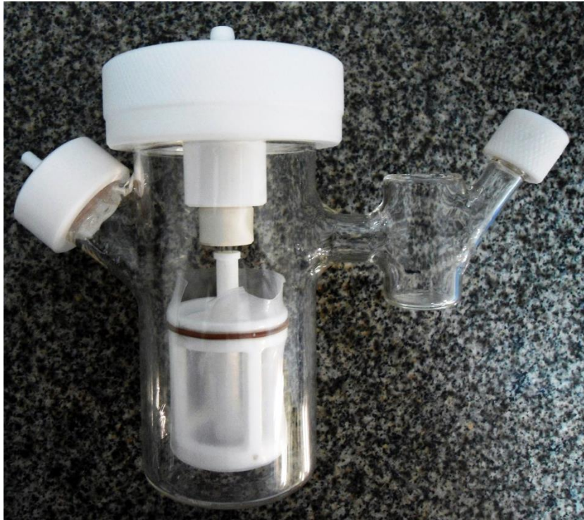
Figura 7. Protótipo do BEVT utilizado nos experimentos de cultivo da linhagem hMSCs-TERT, com o agitador (cilindro interno) e membrana de silicone.
