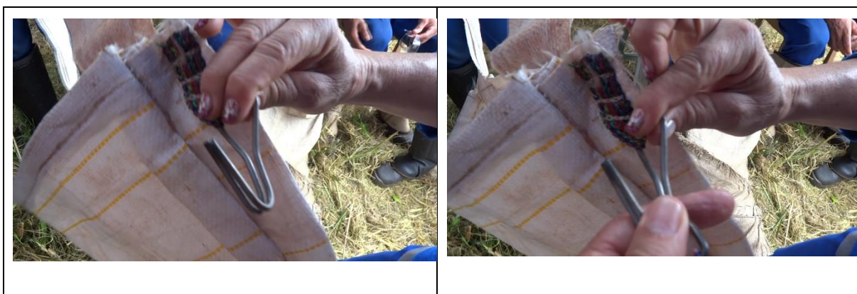
Figura 38. Ganchos de sustentação do fundo falso.
