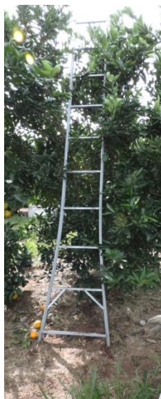
Figura 62. Escada em formato ‘A’, considerada mais adequada à tarefa de colheita manual de laranja.
