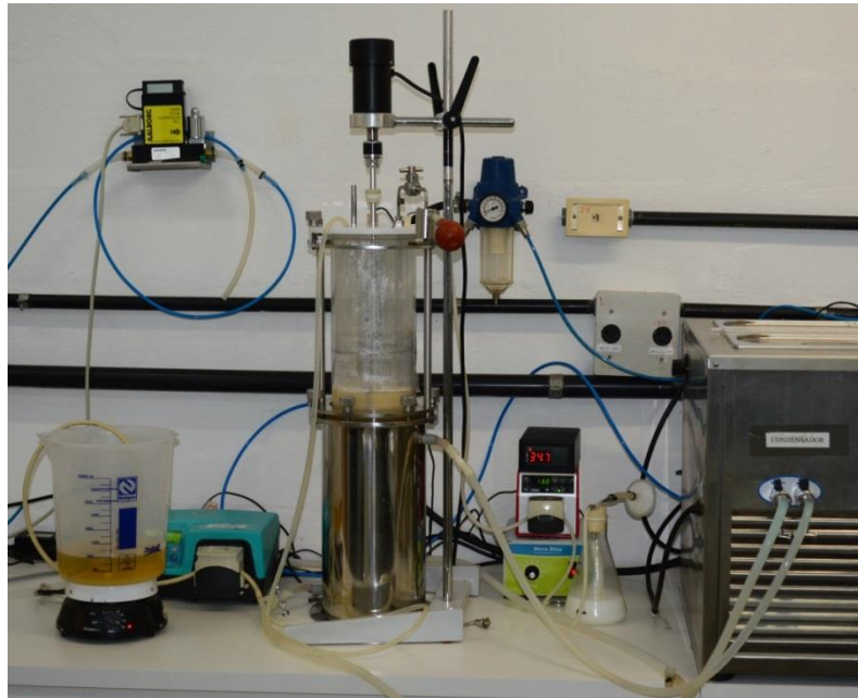
Figura 5.2 – Imagem da bancada de trabalho empregada nos experimentos de fermentação em batelada alimentada.
