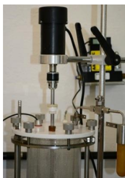
Figura 4.1 – Foto da parte superior do biorreator com detalhe do sistema de agitação.
