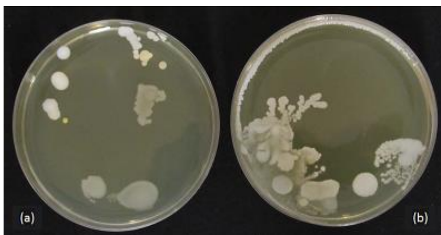
Figura 77: Placas de Petri contendo o inóculo do filtro modificado (a) e do filtro não modificado (b) com Ag/TiO 2 incubados durante 48 h. - Teste 1.
