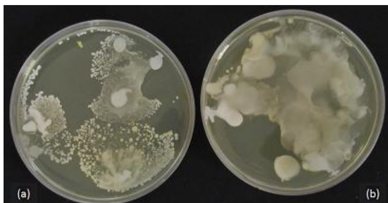
Figura 72: Placas de Petri contendo o inóculo do filtro modificado (a) e do filtro não modificado com prata (b) incubados durante 48 h. - Teste 2.
