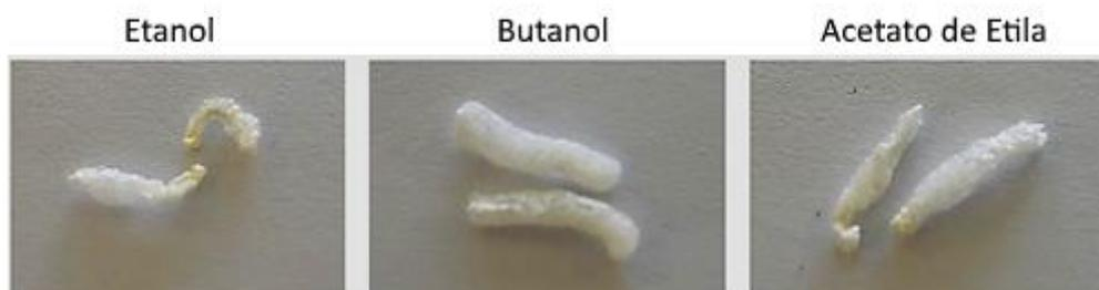
Em virtude de o butanol apresentar toxicidade, e isto reduzir o leque de aplicações do material, testamos a desidratação apenas com etanol, seguindo um dos protocolos de secagem de material vegetal, o que não apresentou bom resultado em relação a retirada de água, com colapso do material formado (Figura 26).
