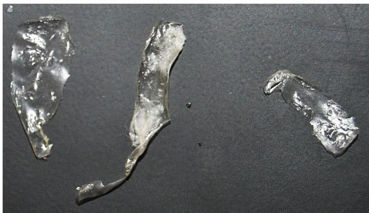
Portanto, com o intuito de manter a integridade do material, o procedimento de gelificação por congelamento e secagem com troca de solventes até o butanol foi a alternativa mais eficiente para o procedimento desenvolvido.
