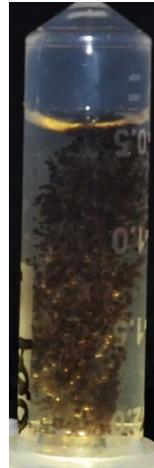
A adição de grãos de café permitiu a retirada do compósito do microtubo e bom manuseio da estrutura sem perda de integridade e permitiu a secagem em estufa sem colapso e mantendo de forma efetiva a integridade do gel, sem a necessidade do uso da etapa de troca de solventes (Figura 28).
