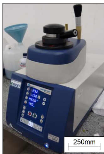
Figura 3.7. Detalhe da máquina utilizada no embutimento das amostras.
