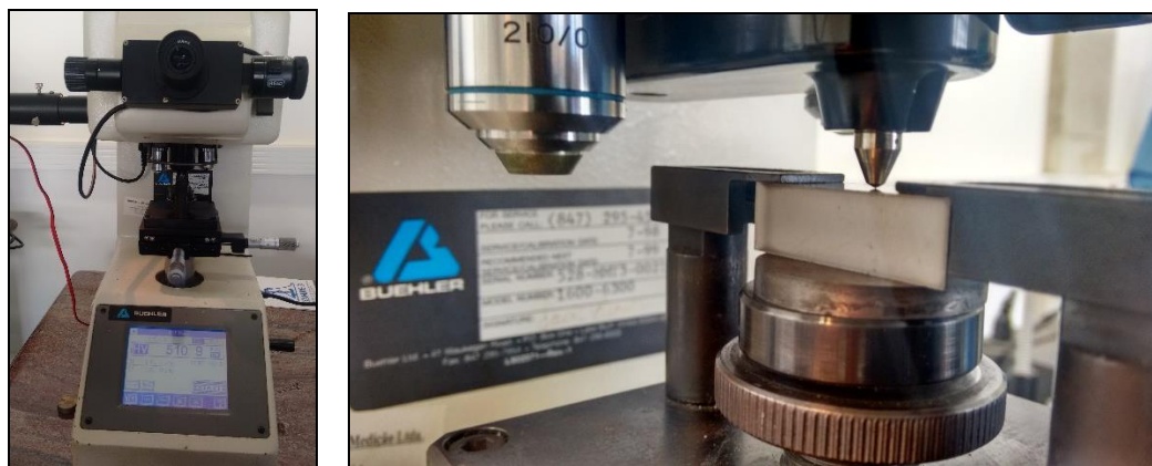
Figura 3.16. Equipamento de medição de microdureza, com detalhe para o contato do penetrador na amostra.
