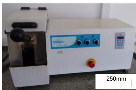
Figura 3.4. Cortadeira utilizada para preparação da amostra.
