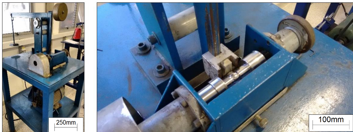
Figura 3.13. Equipamento de teste de desgaste de esfera presa.
