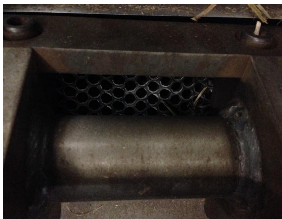
Figura A.2 – Interior do moinho de facas e a peneira de 1 mesh.
