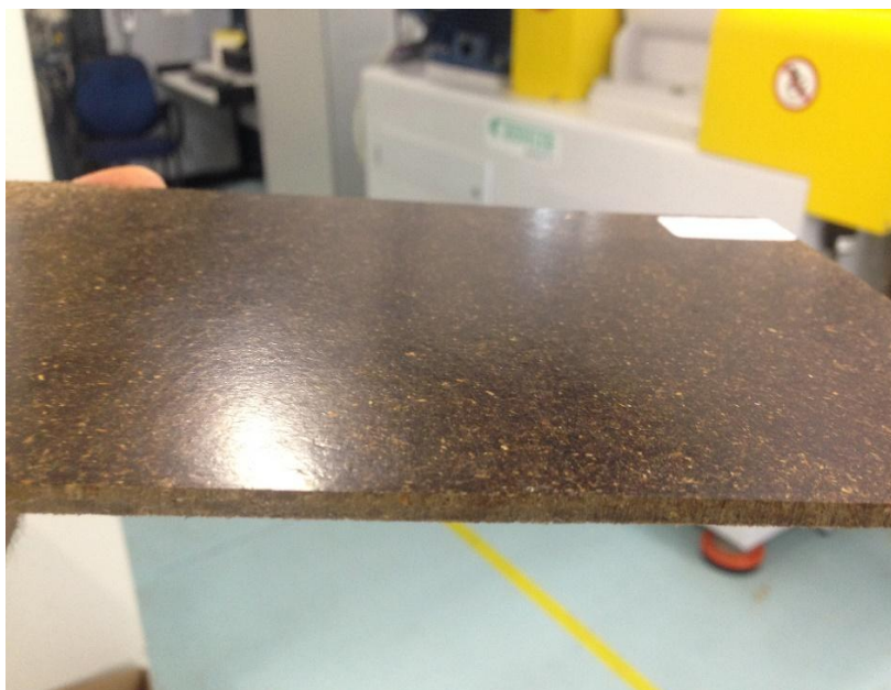
Figura 5.16 – Painel composto com 80% de fibra de gravatá e 5% de PPAM.
