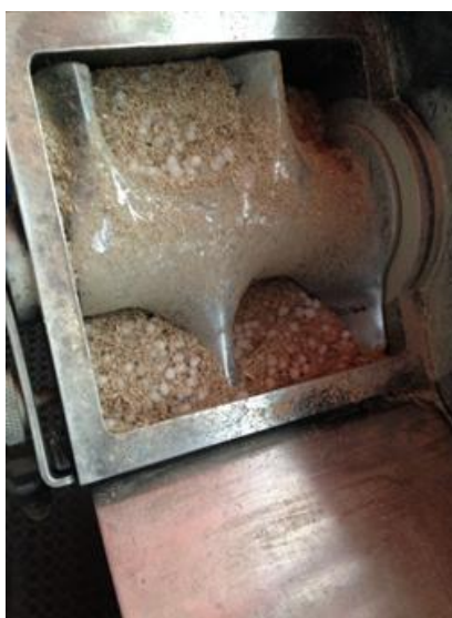
Figura 4.4 - Foto da câmara interna do equipamento preenchida com as fibras moídas e os pellets de PP.
