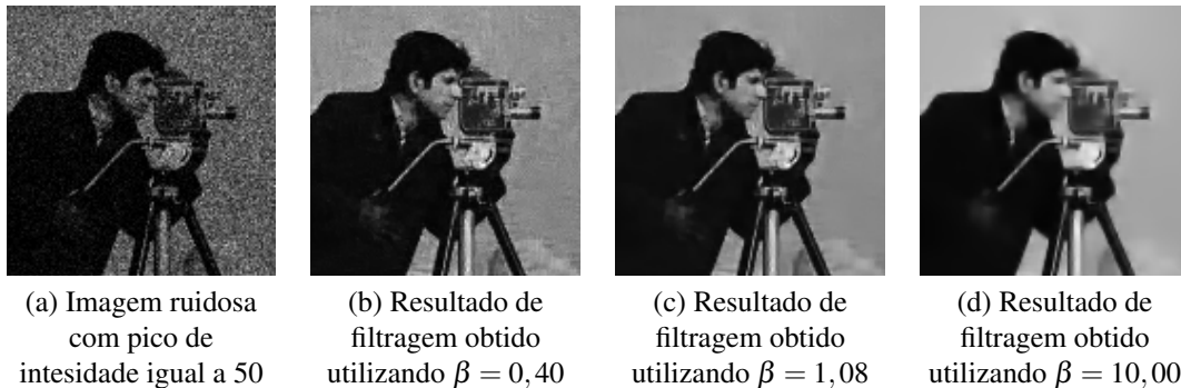
Figura 4.7: Resultados de filtragem obtidos utilizando o algoritmo WPNL-Wiener com diferentes valores para o parâmetro \beta .
