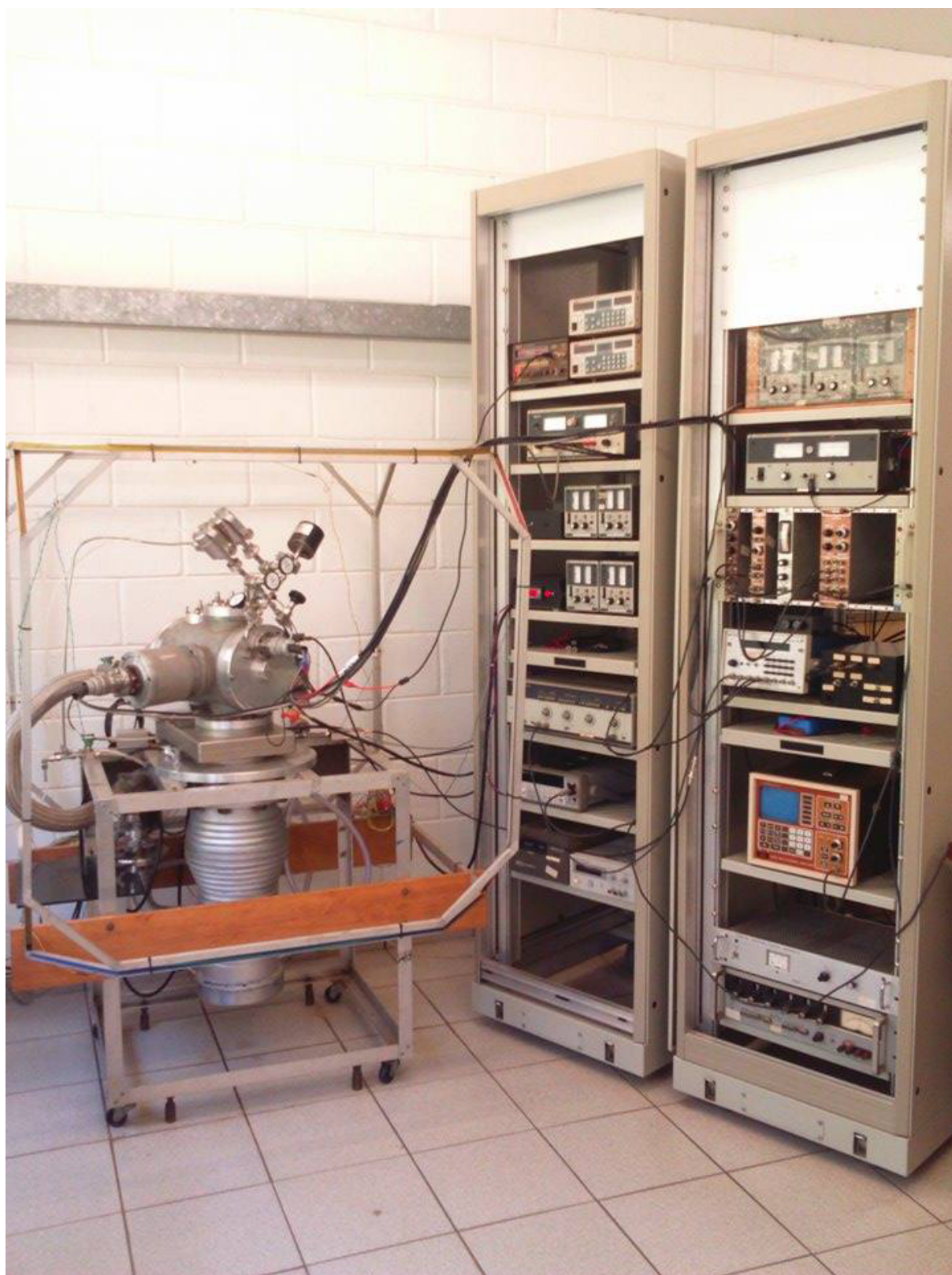
FIGURA 3.6: Foto do espectrômetro de massa por tempo de voo do LCEF do DQ-UFSCar 25 .
