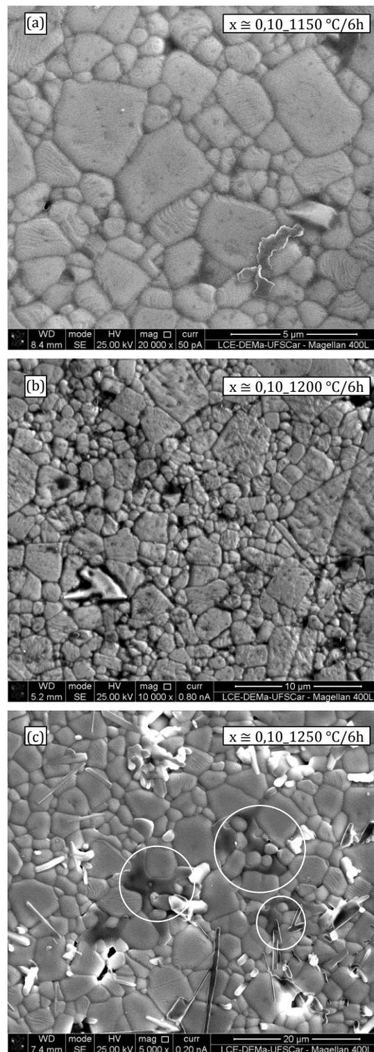
Figura 4.20 - Morfologia das microestruturas obtidas em superfícies polidas e atacadas termicamente de amostras LLTO<sub>0,10</sub> sinterizadas em diferentes temperaturas por 6h, sendo: (a) 1150°C / 6h (b) 1200°C / 6h e (c) 1250°C / 6h.
