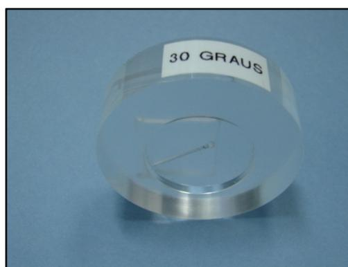
Figura 35 – Colimador que restringe a passagem de partículas alfa com ângulo de  $30^\circ$ .
