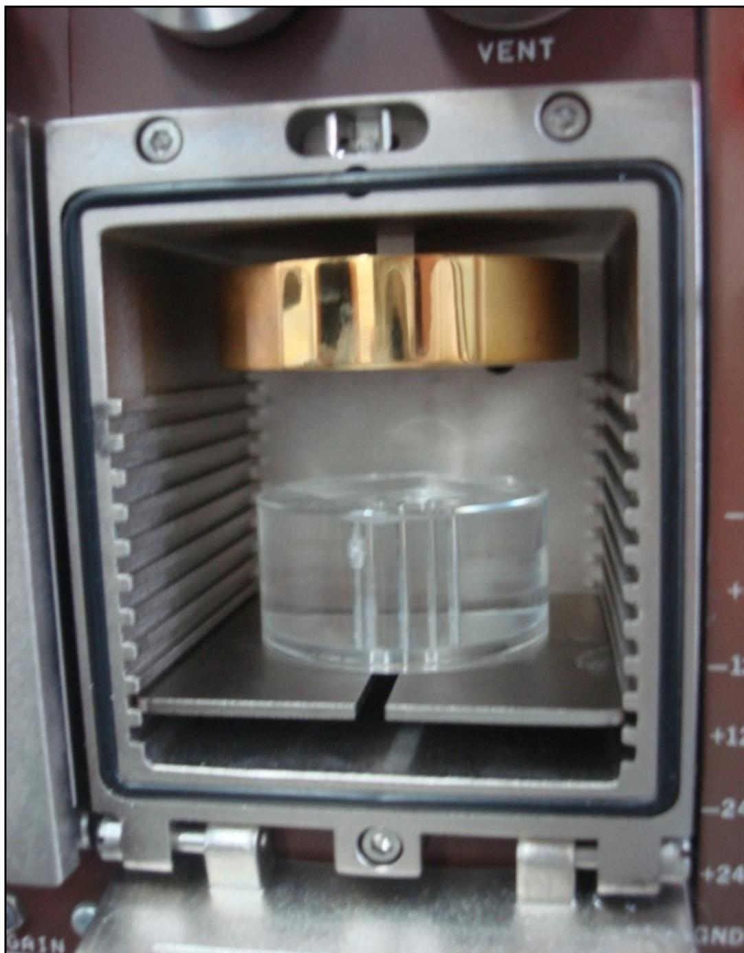
Figura 41 - Câmera de vácuo e um colimador com ângulo de incidência de  $90^\circ$ .
