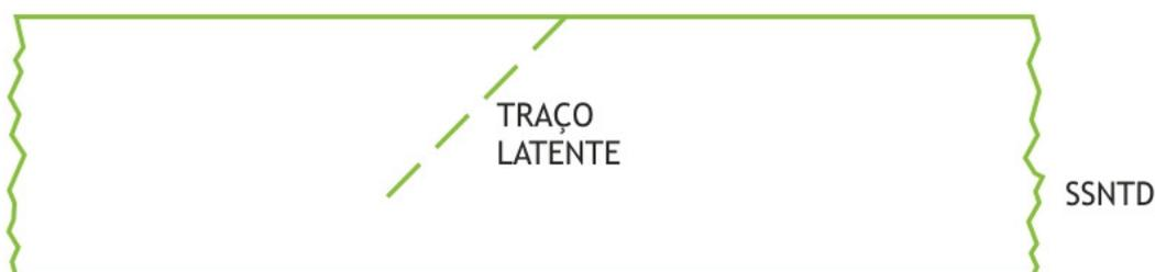
Figura 6 - Traço latente em um SSNTD.
