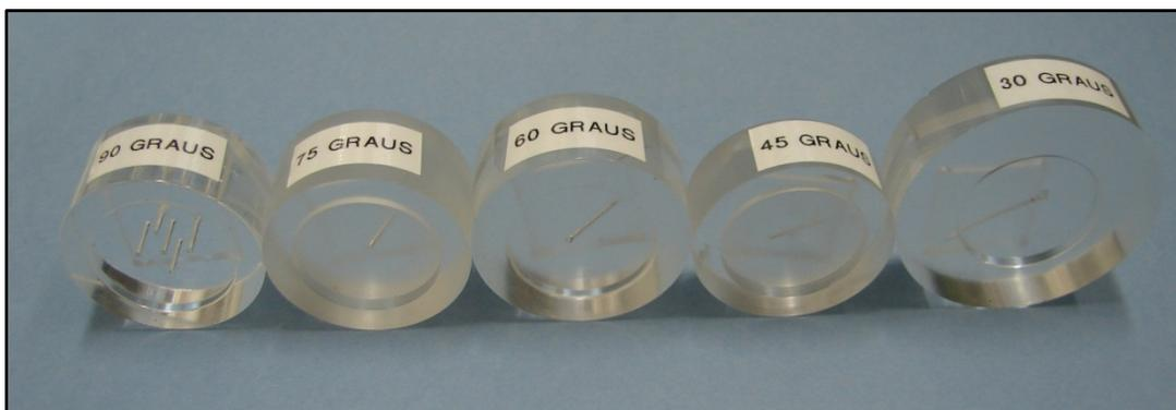
Figura 34 – Colimadores de  $90^\circ$ ,  $75^\circ$ ,  $60^\circ$ ,  $45^\circ$  e  $30^\circ$ .
