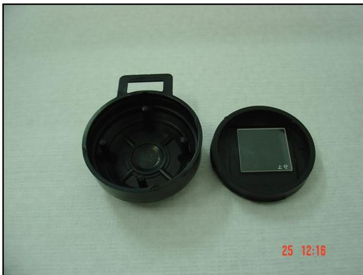
Figura 11 - CR-39 (plástico transparente) dentro de uma câmara de difusão.
