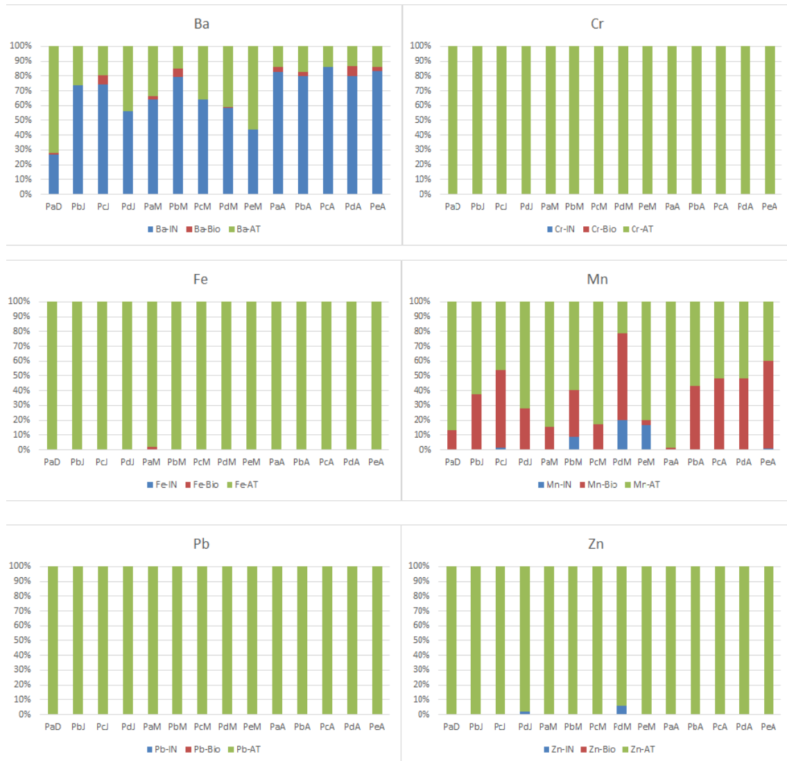
Figura 10 – Gráfico comparativo da porcentagem de metais presentes nas amostras IN°, BIO° e AT° (Fonte: própria). Legenda: Pa= ponto 1; Pb= ponto 2; Pc= ponto 3; Pd= ponto 4; Pe= ponto 5; D= Dezembro/2015; J= Janeiro/2016; M= Março/2016; A= Abril/2016;
