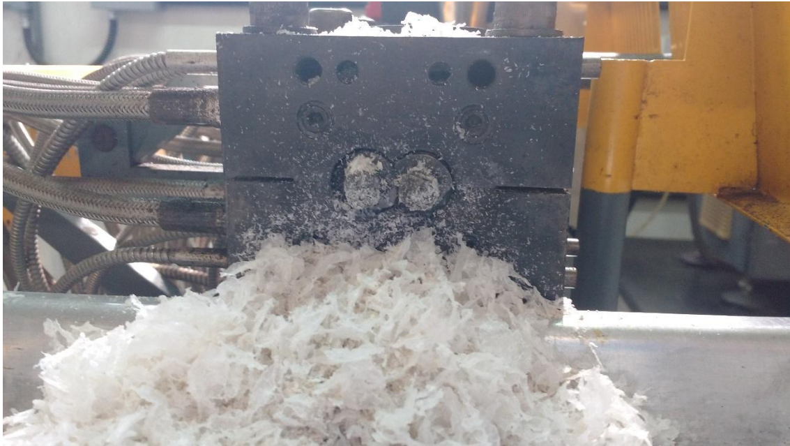
Figura 3.5 - Fotografia do compósito PP/PP-g-MAH/NFC após a técnica de pulverização por cisalhamento no estado sólido (S3P).
