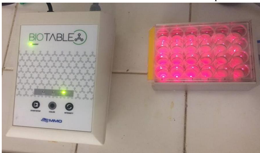
Figura 6. Biotable a base de LED's de 780 nm. Fonte: Elaborada pela autora.
