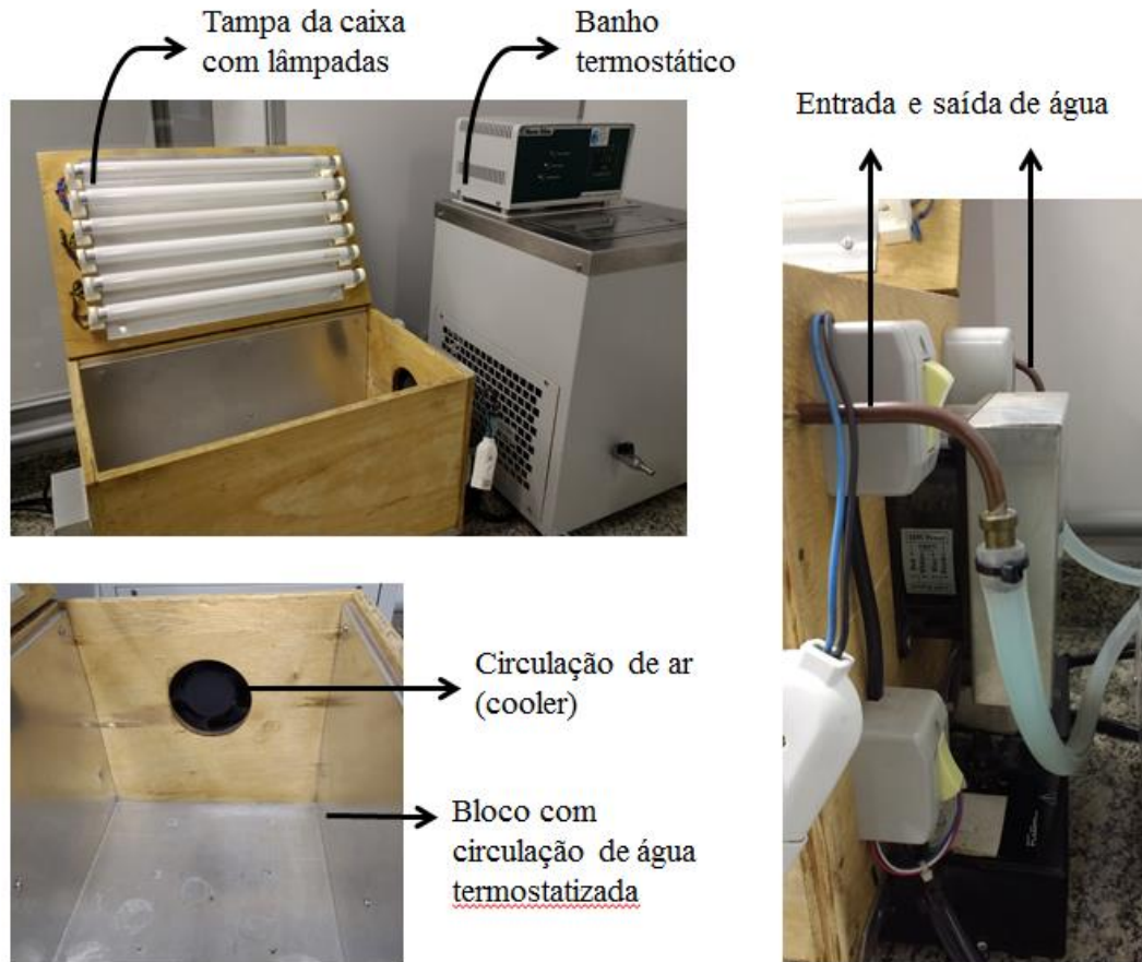
FIGURA 3.6 - Imagens do fotorreator utilizado nos ensaios fotocatalíticos.
