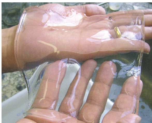
Figura 4 – Hidrogel de PAAm-MC: liberação controlada de insumos
