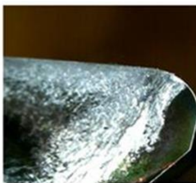
Figura 4.30 - Adesão de alumínio na superfície de saída da ferramenta com filme DLC 20%N 2 após 3,2 metros lineares de usinagem
