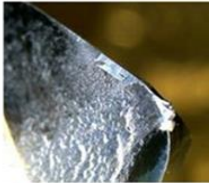
Figura 4.31 – Aresta postiça na ferramenta com filme DLC20%N 2 após 5,7 metros lineares de usinagem
