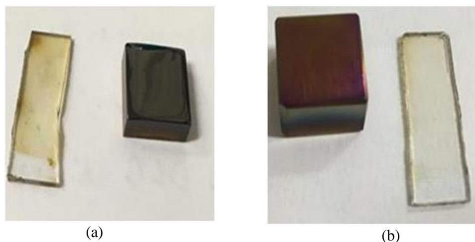
Figura 4.11 – Foto do filme de a-C:H(N) nos substratos de vidro e liga de titânio com fluxo total dos gases de: (a) 40sccm e (b) 30 sccm
