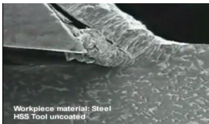
Figura 2.13 – Imagem da aresta postiça de corte em ferramenta de HSS
