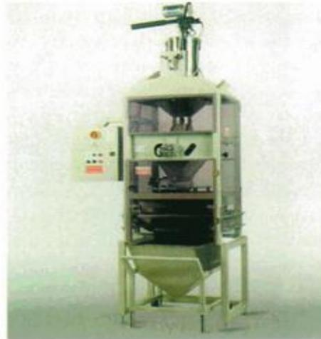
Figura 2.4. Equipamento de aplicação de granilhas [2].
