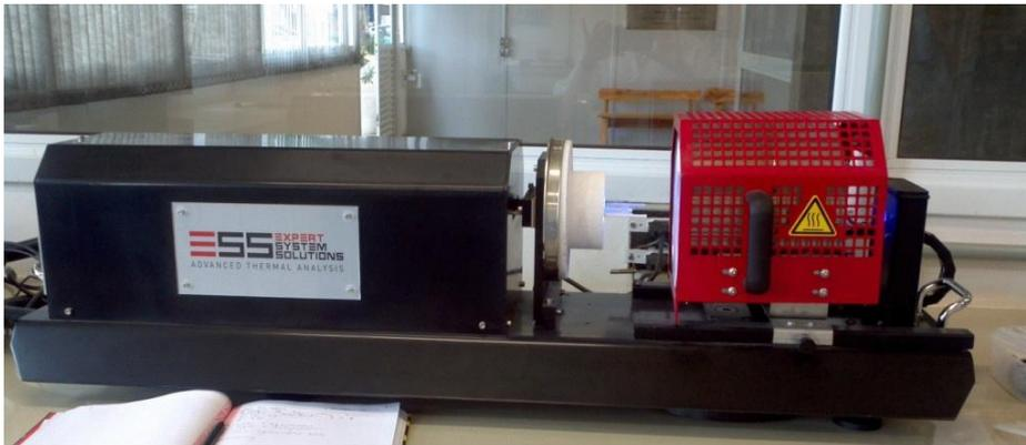
Figura 3.2. Microscópio de aquecimento Expert System Solutions modelo Misura 3 HSML FLEX 1600-30. SENAI Rio Claro, SP.
