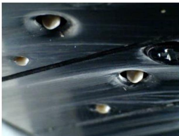
Figura 2.5. Bocais de cabeçote usado na esmaltação digital [24].
