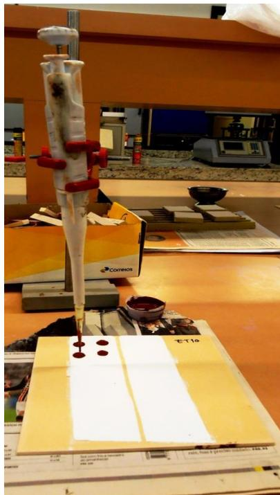
Figura 3.1. Montagem experimental para aplicação das tintas digitais sobre a superfície de esmalte seca.
