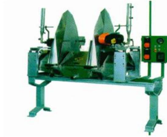
Figura 2.3. Equipamento de aplicação de esmalte por disco [2].
