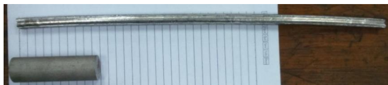
Figura 4.27. Amostra antes do processamento de forjamento rotativo, abaixo; e após o passe 8, acima.
