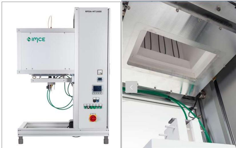
Figura 7 – Equipamento para Determinação do Módulo Elástico pela Técnica de Excitação por Impulso (RFDA HT1600)
