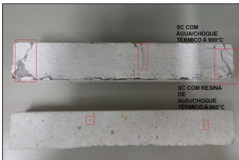
Figura 6 – Corpos-de-Prova com e Sem Resina Após Choque Térmico
