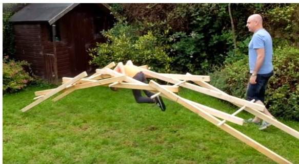
FIGURA 27: Estrutura da ponte de Da Vinci
