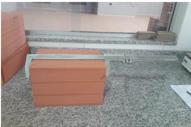
Tabela 6. Valores médios das dimensões (largura, altura e comprimento em mm) dos blocos cerâmicos padrão, com adição de 20% de lodo e 5% de lodo.
