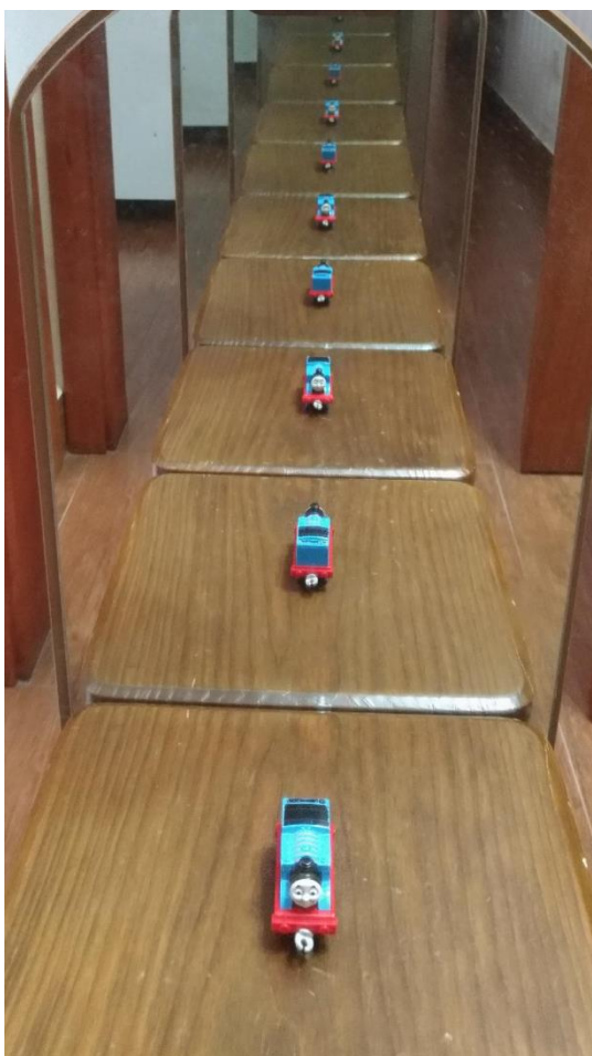
Figura 3.11 – Efeito do espelho infinito observado colocando-se um objeto entre dois espelhos planos dispostos paralelamente um de frente para o outro.
