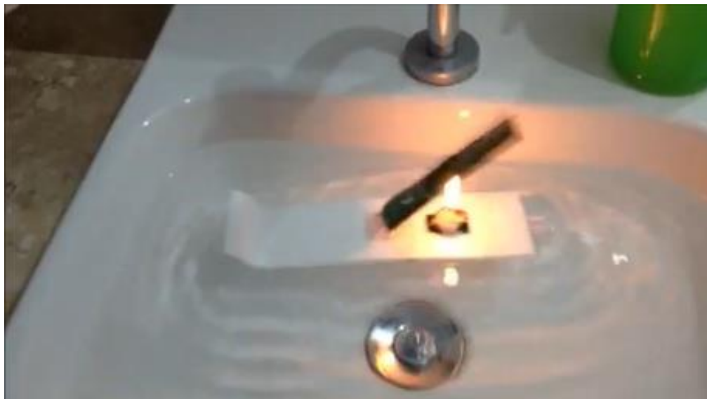
Figura 3.7 – Experimento do barquinho a vapor em funcionamento.
