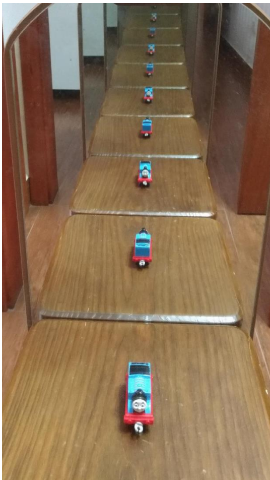
Figura A.3.3 – Efeito do espelho infinito observado colocando-se um objeto entre dois espelhos planos dispostos paralelamente um de frente para o outro.
