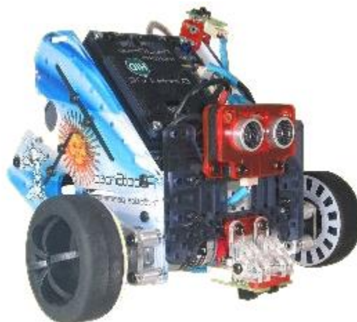
Figura 11 - Robô móvel controlado a partir da plataforma UNC++Duino
