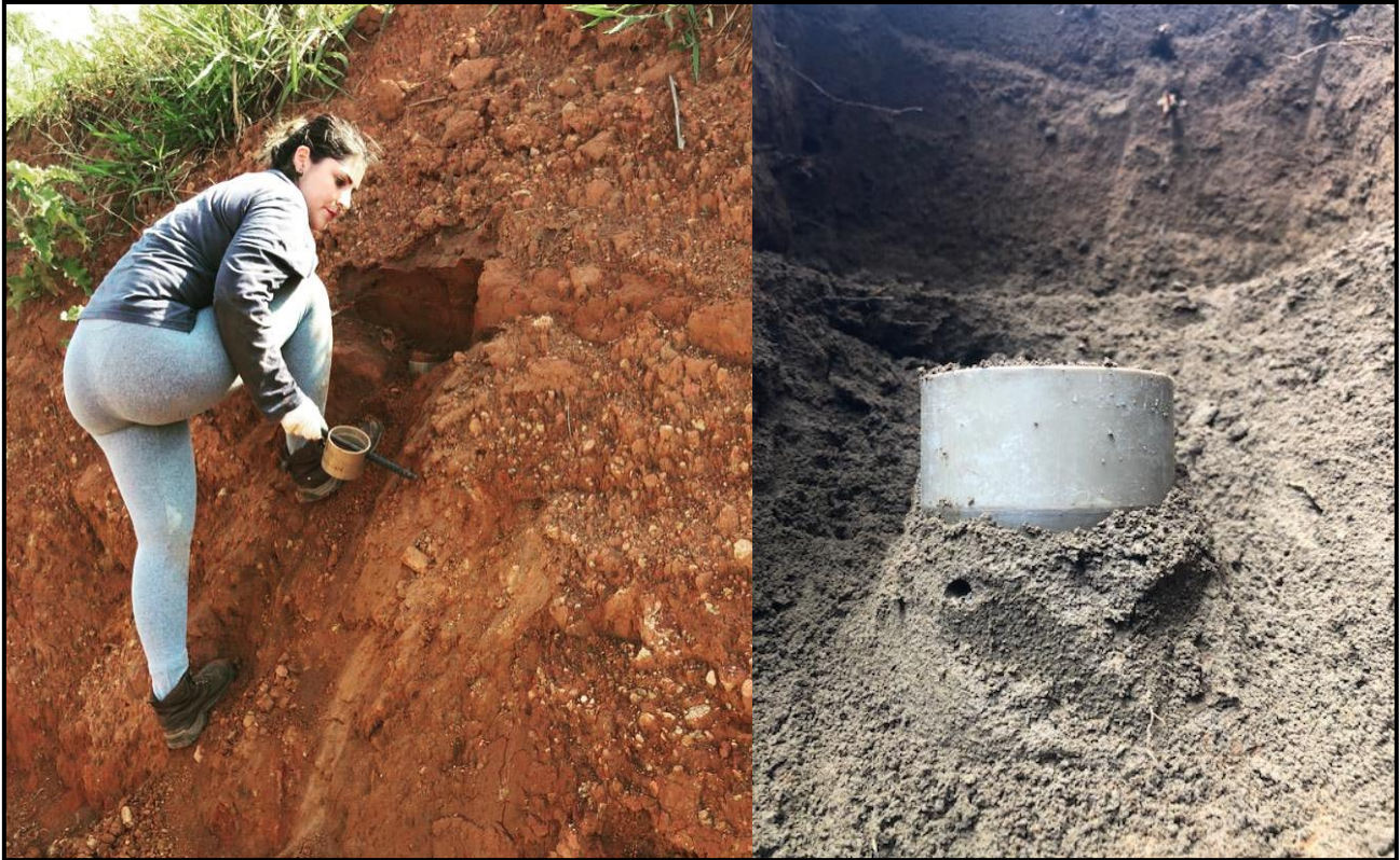
Figura 35. Anéis de PVC para coleta de amostras indeformadas.
