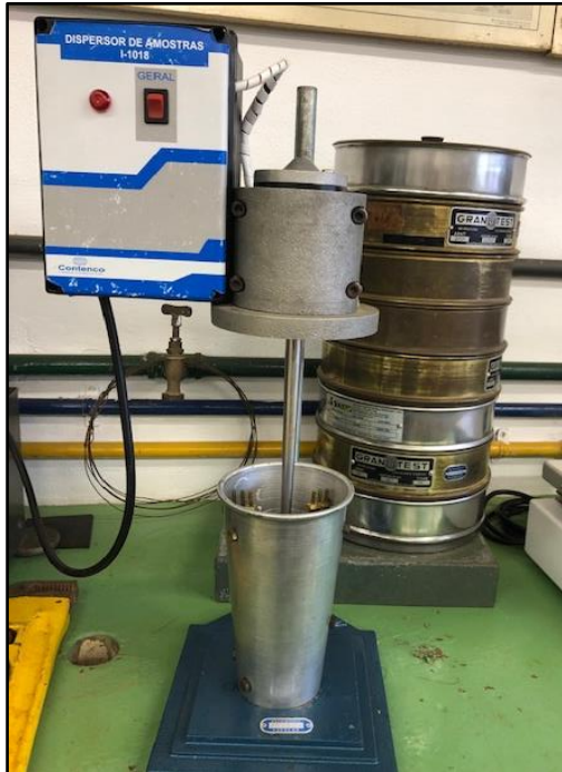
Figura 26 Peneiras e dispersor utilizados durante o ensaio de granulometria conjunta
