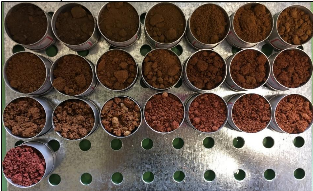
Figura 32. Amostras de perfil de monitoramento de umidade, na qual cada cápsula representa 20cm de profundidade, iniciando em 20cm e terminando em 440cm.
