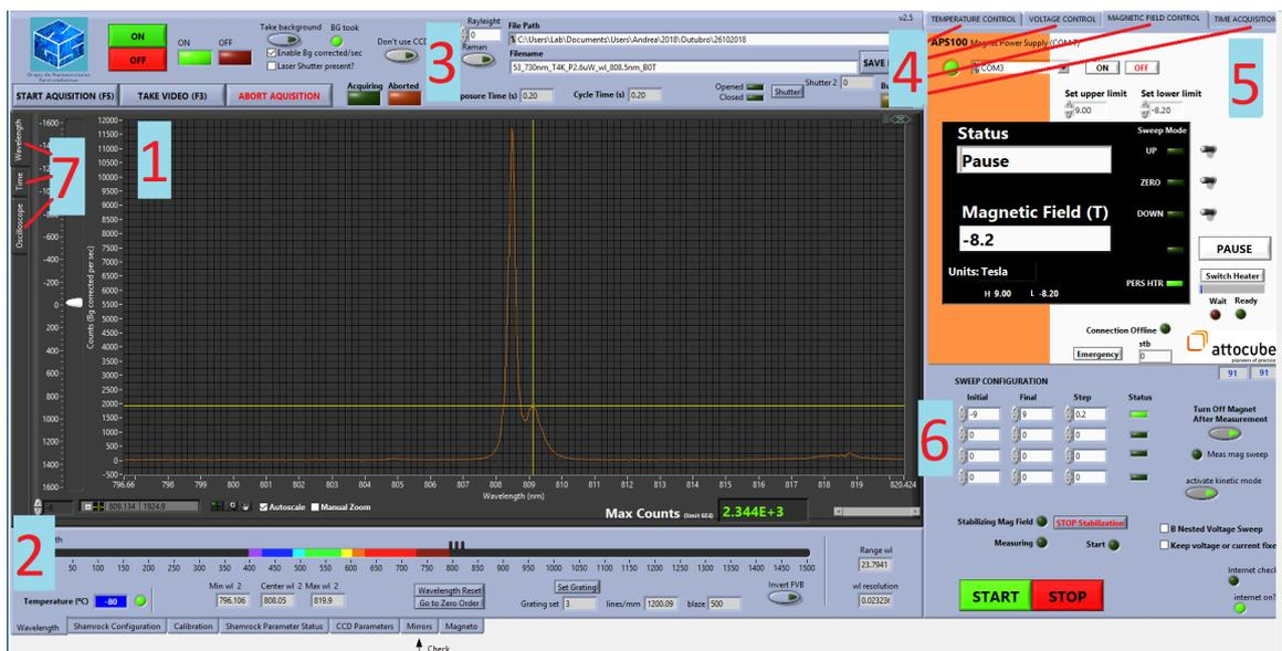
Figura B.2: Programa principal: 1) Janela para observação dos espectros; 2) configuração do espectrômetro; 3) configuração da CCD; 4) Abas para acesso dos outros equipamentos; 5) painel de controle do campo magnético; 6) controle de automação das medidas experimentais; 7) Abas para selecionar outros equipamentos de medida, como fotomultiplicadora para medidas de tempo de vida ou osciloscópio
