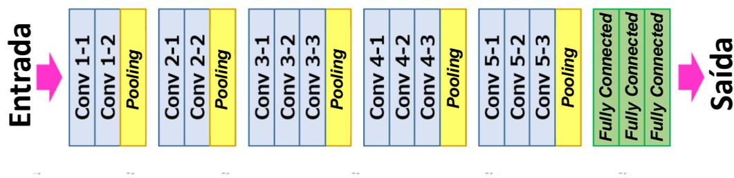
**Figura 1.4:** Arquitetura da rede neural VGG-16, CNN com 16 camadas de convolução e completamente conectadas. Fonte: Adaptada de Prabhu (2018).
