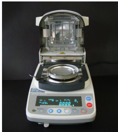
Figura 8 - Balança determinadora de umidade.
