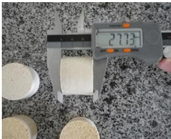
Figura 10 - Medida da expansão longitudinal dos briquetes.
