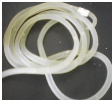
Figura 36: Amostra extrudada de nanocompósito de TPS com microfibrilas de celulose.
