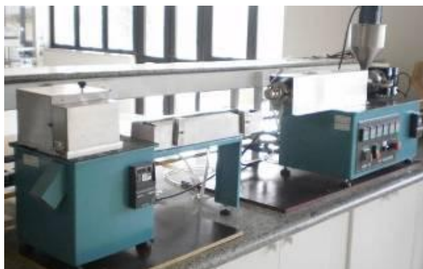
Figura 13: Extrusora de rosca simples.
