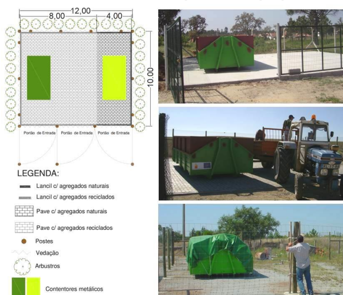
Figura 29. Locais de armazenamento temporário de pequenos volumes de RCC.
