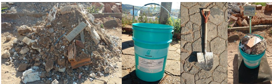
Figura 38. Procedimento de amostragem física NBR 10.007:2004.
