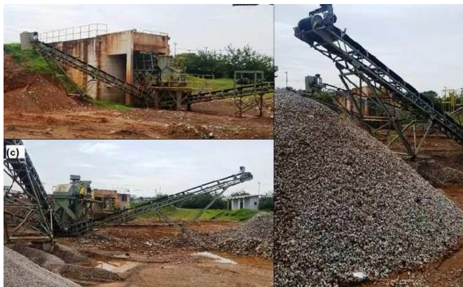
Figura 17. Usina recicladora de parceria público-privada CONSIMARES, sede em Hortolândia/SP. (A) vista do britador; (B) correia transportadora após classificação e (C) classificador.
