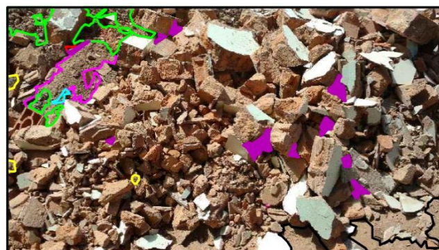
Figura 56. Caracterização dos RCC a imagens fotográfica no Autocad - Construtora B.
