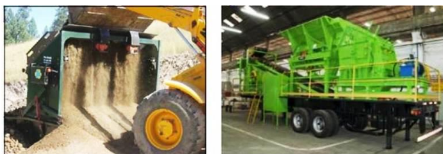
Figura 23. Equipamentos móveis: Peneira vibratória e triturador de reciclagem do CISBRA.
