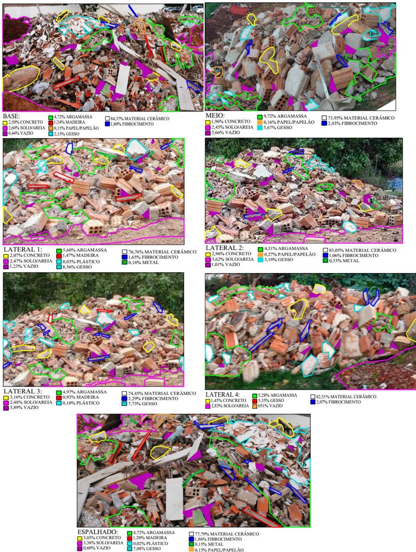
Figura 59. Caracterização dos RCC a imagens fotográfica no Autocad - Construtora E.
