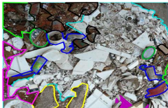
Figura 60. Caracterização dos RCC a imagens fotográfica no Autocad - Construtora F.
