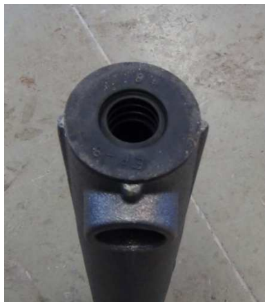
Figura 3.8: Borracha de vedação da luva metálica grauteada.
