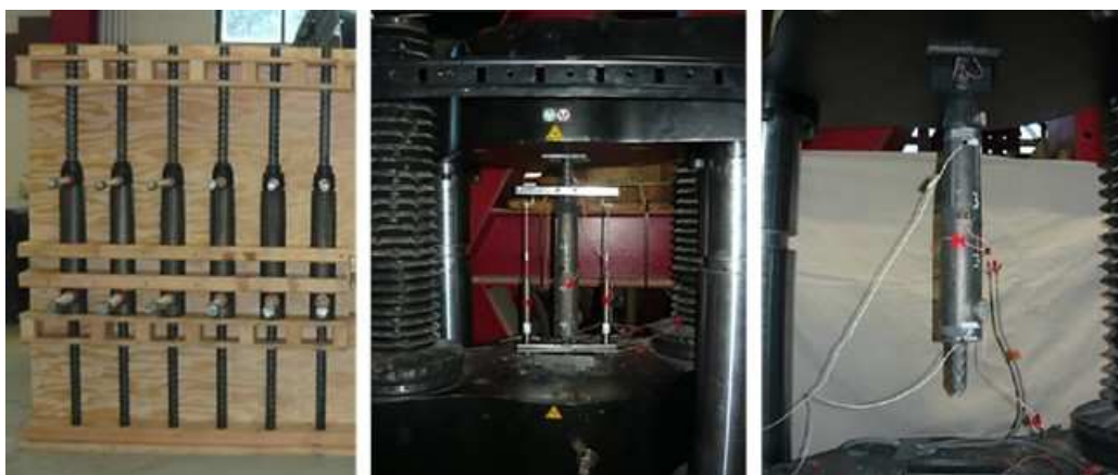
Figura 1.4: Ensaio de tração em luva metálica grauteada (ruptura com 169% de f_{yd} )
