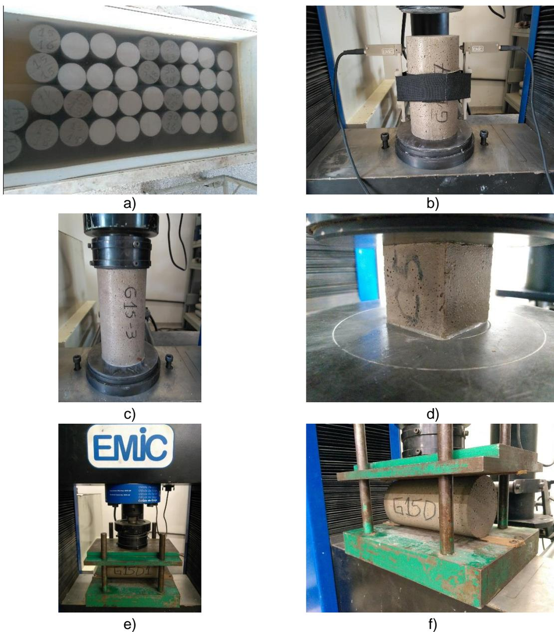
Fonte: Autor (2019). Legenda: a) Tanque de cura dos corpos de prova; b) Ensaio de módulo; c) Compressão de CP cilíndrico; d) compressão de CP cúbico; e) e f) Tração na compressão diametral.
