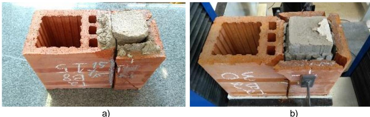
Fonte: Autor (2019). Legenda: a) Fissura formada atravessando graute 15 MPa; b) fissura formada na interface da parede central com o graute 30 MPa.
