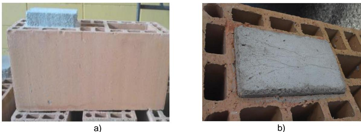
Fonte: Izquierdo (2015), p. 200. Legenda: a) Corpo de prova antes do ensaio de empurramento; b) Corpo de prova depois do ensaio de empurramento.
