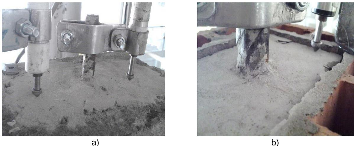
Fonte: Izquierdo (2015), p. 221. Legenda: a) Corpo de prova antes do ensaio de arrancamento; b) Corpo de prova depois do ensaio de arrancamento.
