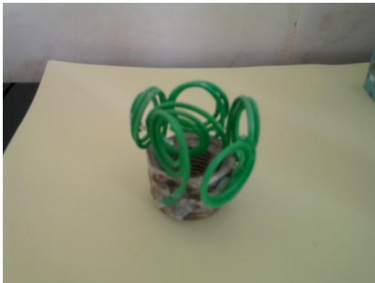
Figura 19: Foto do suporte produzido para as deposições de HMDSO via plasma.
