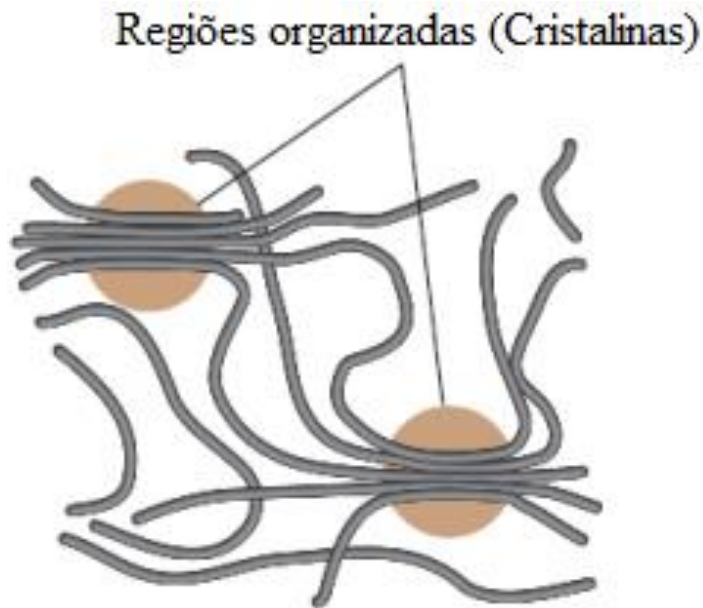
FIGURA 3.4 - Morfologia de um polímero semicristalino (TORRES, 2007).
