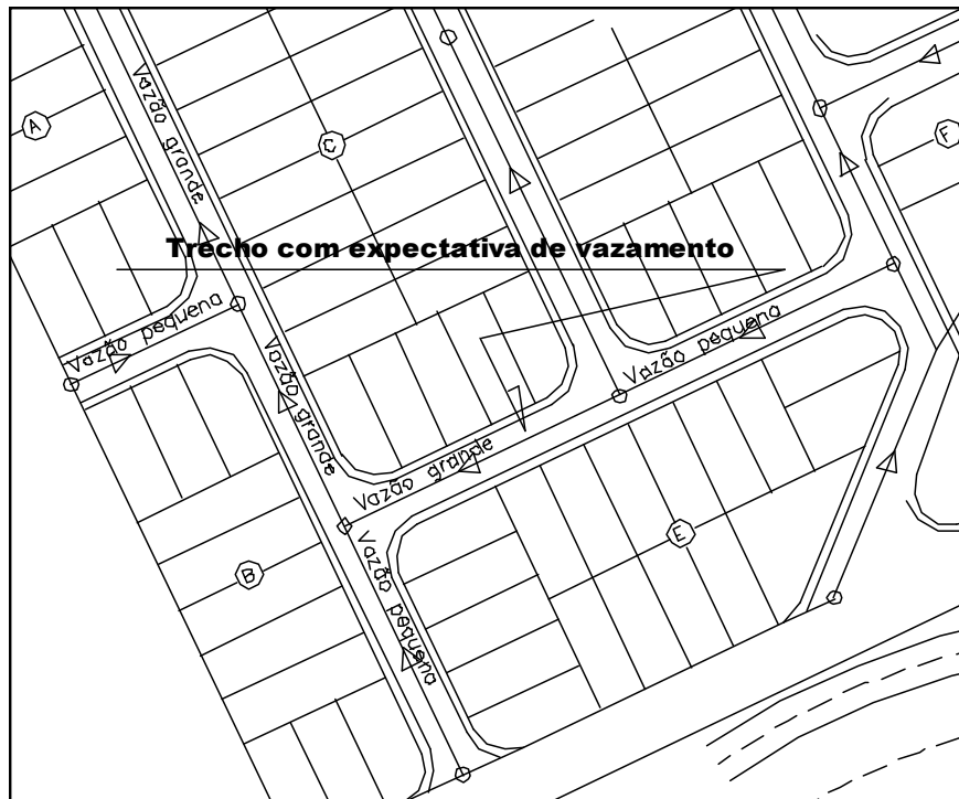
FIGURA 6.46 – Procedimentos para detecção de vazamentos orientados pela vazão de infiltração da rede coletora
