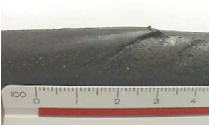
FIGURA 4.14 - Furo provocado por equipamento que estrangula o fluxo de água - ROCHA (2001)
