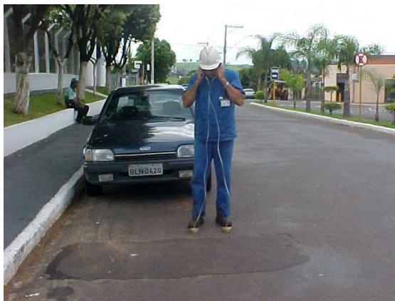
FIGURA 6.45 – Busca de vazamentos com o geofone
