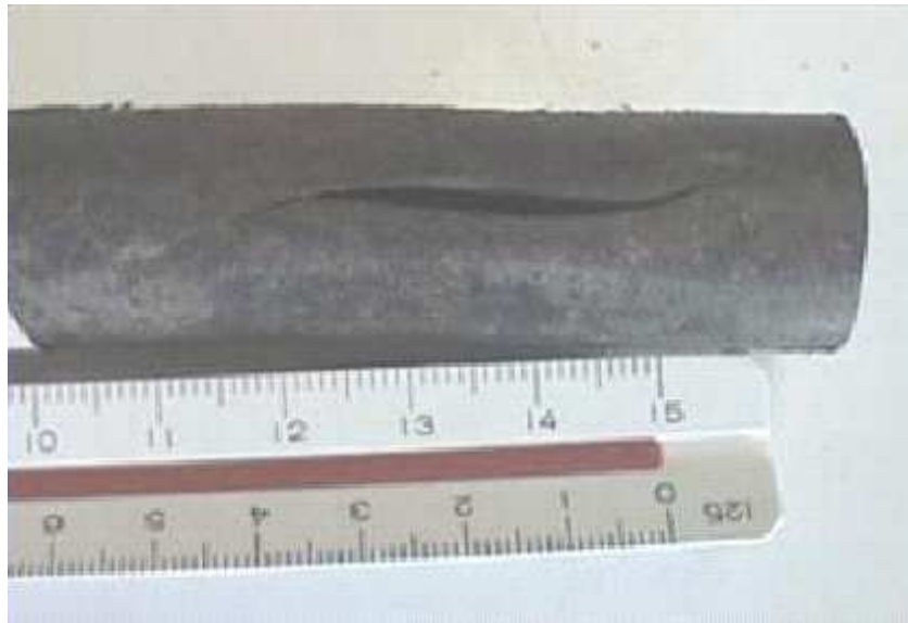
FIGURA 4.15 - Furo provocado por elemento cortante - ROCHA (2001)
