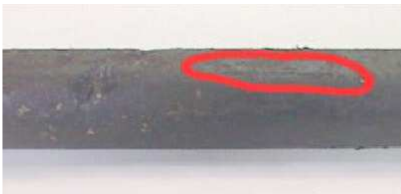
FIGURA 4.13 - Microfuros no trecho central do tubo - ROCHA (2001)
