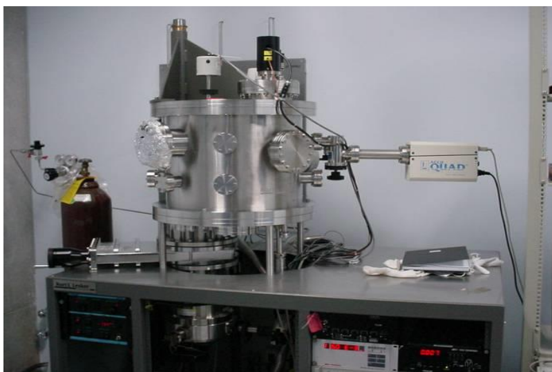
Figura 3.3 - Equipamento utilizado na confecção dos recobrimentos preparados por rf- magnetron sputtering
