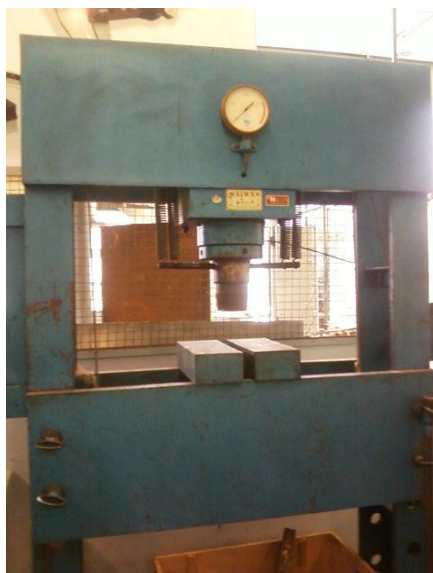
Figura 3.4 - Prensa utilizada na preparação dos alvos de HAp
