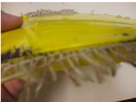
Figura 55 - Vista lateral do compósito. Fonte: próprio autor.
