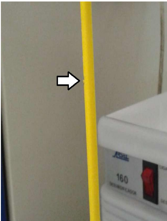
Figura 66 - Início da ruptura na amostra (seta).
