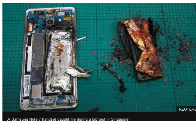
Figura 4.1: Galaxy note 7 após a explosão da bateria
