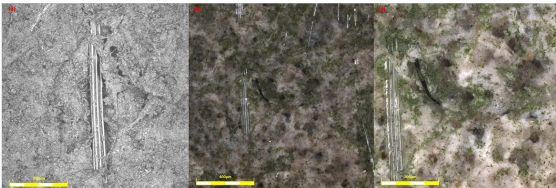
Figura 5.71 – Micrografias obtidas por Microscopia Confocal da superfície de amostra de telha ondulada de fibrocimento: sequencialmente (a,b,c) corpo de prova S0 (sem hidrofugação) [autoria própria].
