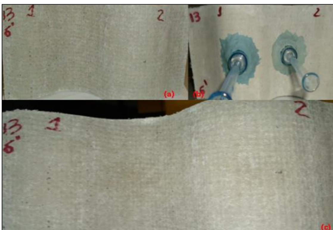
Figura 5.56 – Corpo de prova S13 B: (a, b) sequencialmente face inferior e superior antes do ensaio de permeabilidade; (c) face inferior após tempo final de permeabilidade [autoria própria].
