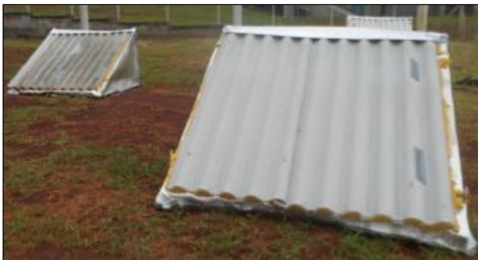
Figura 3.21 – Montagem das estruturas de cobertura para inspeção termográfica e temperatura superficial [5].
