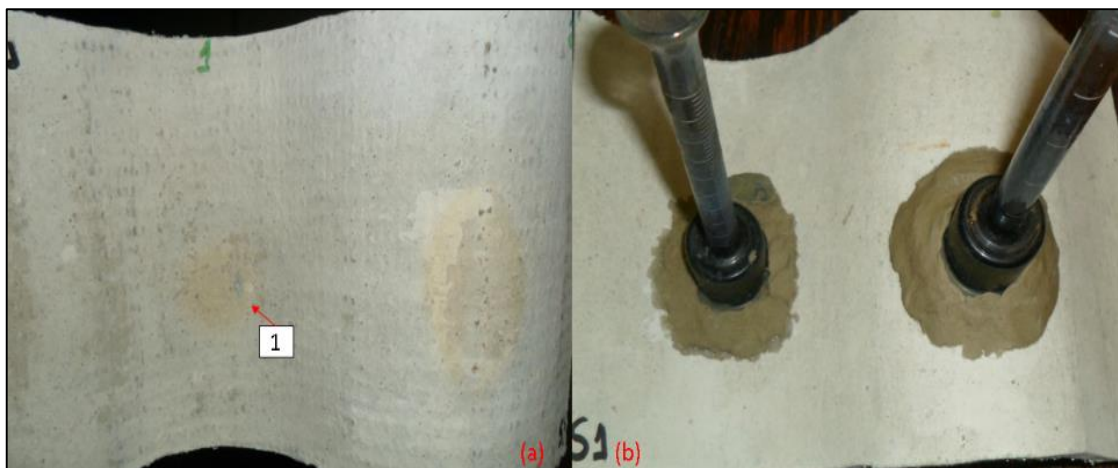
Figura 5.25 – Corpo de prova S1: (a, b) sequencialmente face inferior e superior, superfícies côncava e convexa, após tempo final de permeabilidade [autoria própria].
