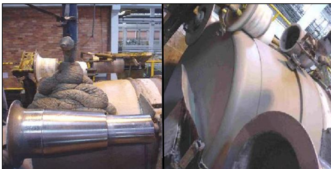
Figura 3.12 – Método Magnani para produção de caixa d’água [13].
