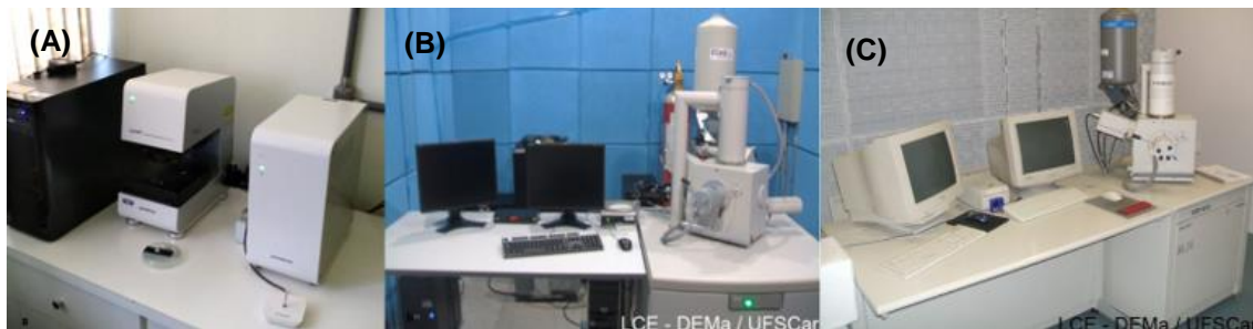
Figura 4.10 – Microscópios utilizados durante as análises microestruturais e química elementar dos corpos de provas: (A) Confocal; (B) MEV FEI Inspect S 50; (C) MEV Philips XL-30 TMP [106].
