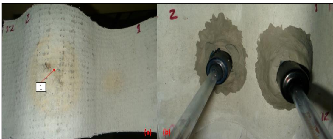
Figura 5.36 – Corpo de prova S12: (a, b) sequencialmente face inferior e superior após tempo final de permeabilidade [autoria própria].
