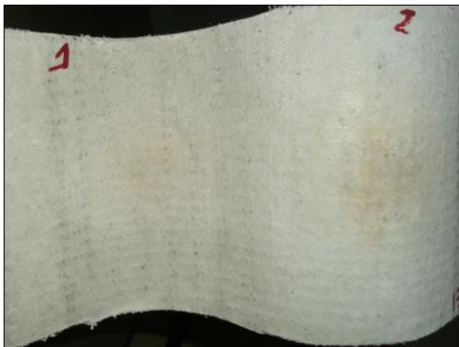
Figura 5.37 – Corpo de prova S13: face inferior, superfícies côncava e convexa, após tempo final de permeabilidade [autoria própria].
