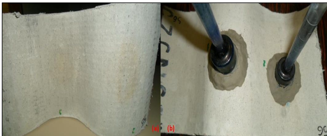
Figura 5.30 – Corpo de prova S6: (a, b) sequencialmente face inferior e superior após tempo final de permeabilidade [autoria própria].
