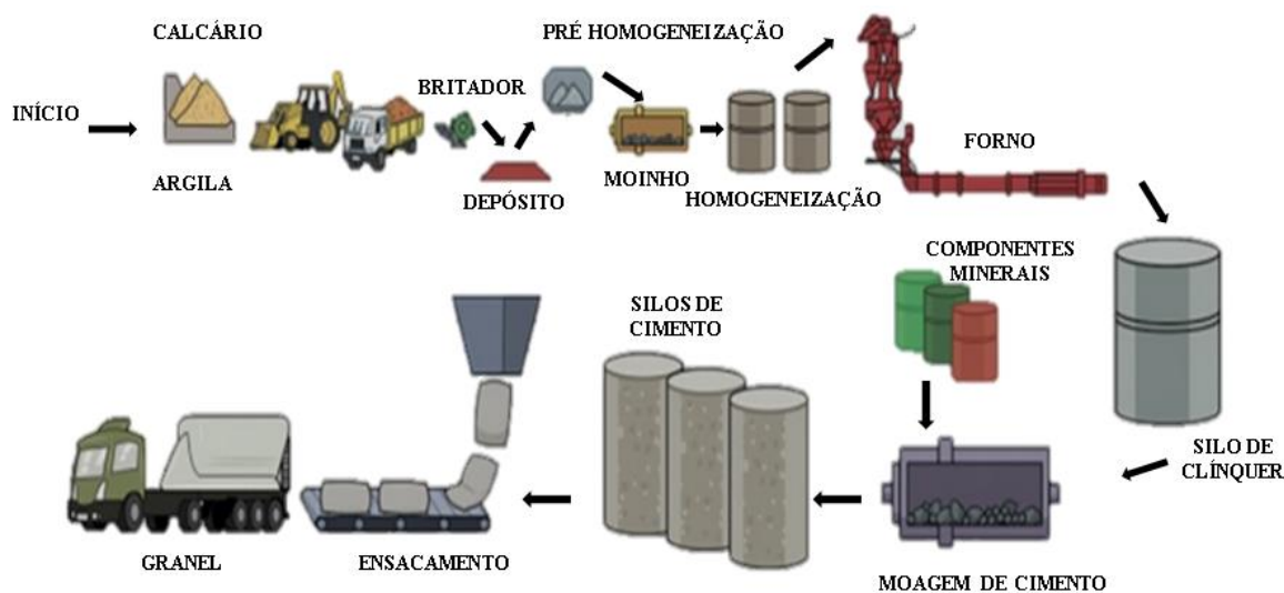
Figura 3.1 – Esquematização do processo de fabricação do cimento Portland. Adaptado de [25].
