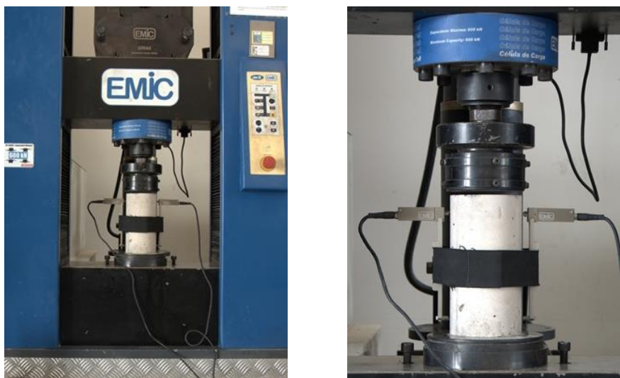
Figura 39 - Máquina de ensaio universal utilizada para a caracterização do concreto
