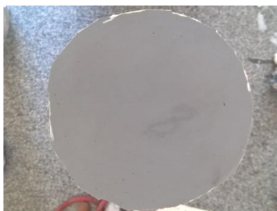
Figura 33 - Face do pilar com após aplicação da massa plástica
