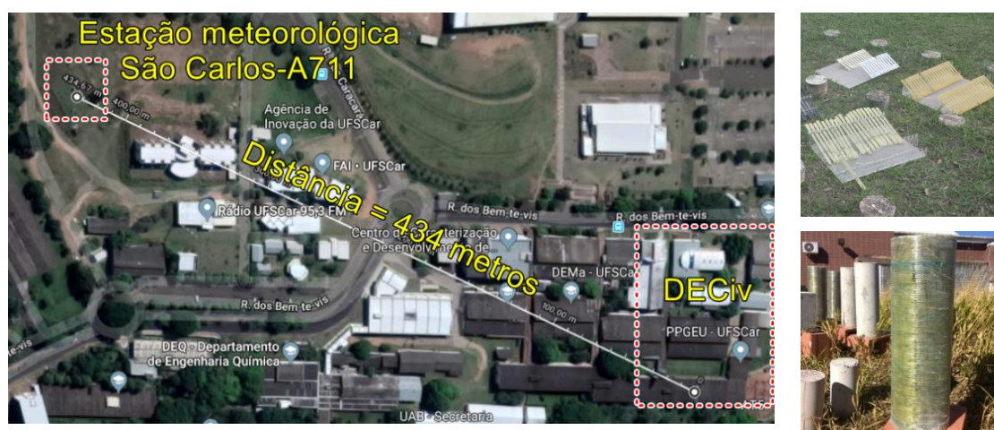
Figura 37 - Locais de exposição de pilares e corpos de prova ao intemperismo
