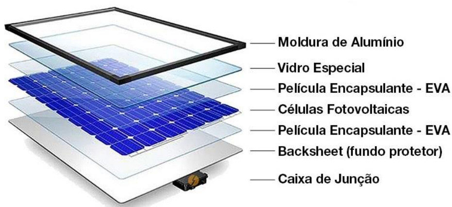
Figura 10- Composição do painel fotovoltaico
