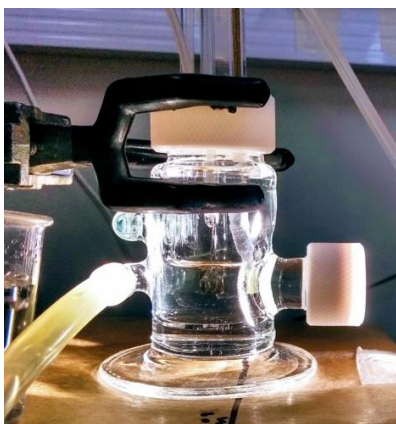
Figura 18: Foto retirada da célula fotoeletroquímica utilizada durante este projeto.
