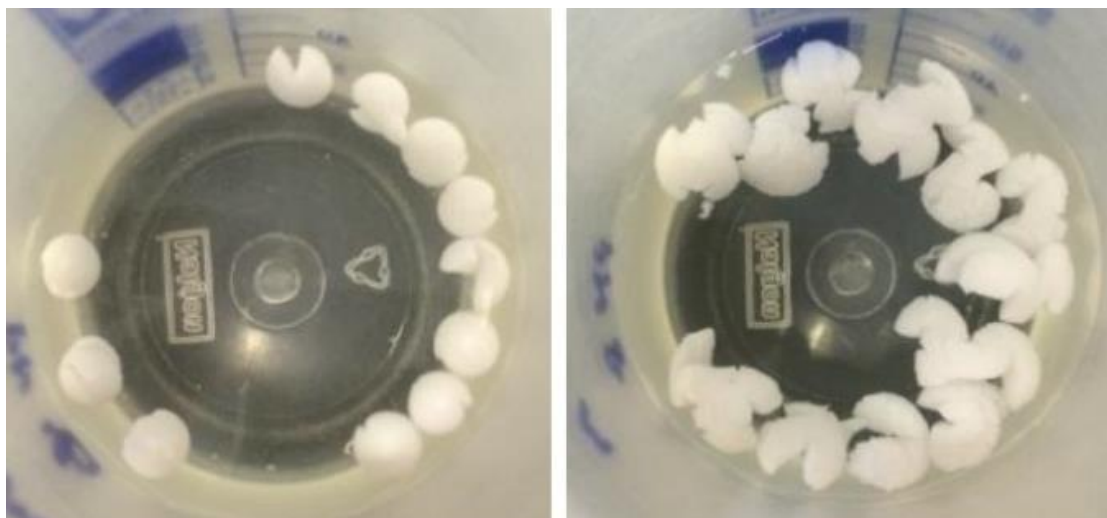
Figura 8. Beads de alginato como o agroquímico Clorotalonil, recobertas com uma monocamada de quitosana abertas após 24 em água com pH neutro.
